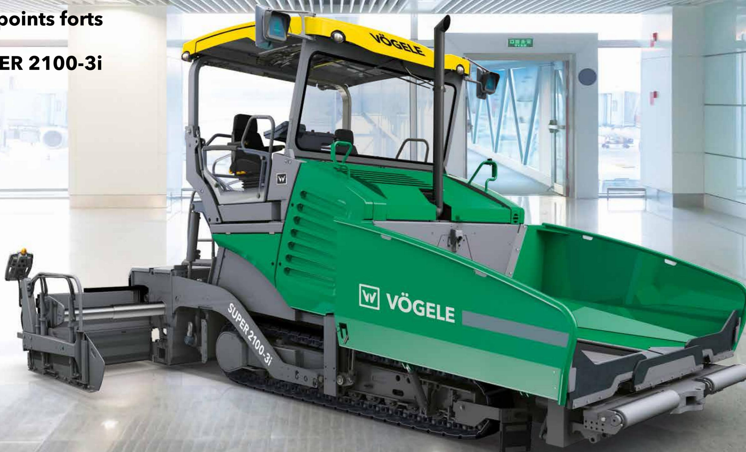
**Finisseur sur chenilles de la Highway Class** couvrant un vaste champ d'applications pour des largeurs de pose jusqu'à 13,0 m
