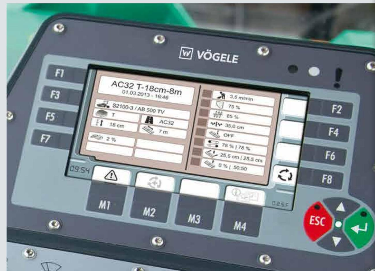
La fonction automatique de programmes de pose permet au personnel opérateur de créer des programmes de pose définis. Il est ainsi possible de mémoriser tous les paramètres importants concernant la pose d'une couche déterminée, par exemple une couche de base en béton bitumineux de 18 cm d'épaisseur.
